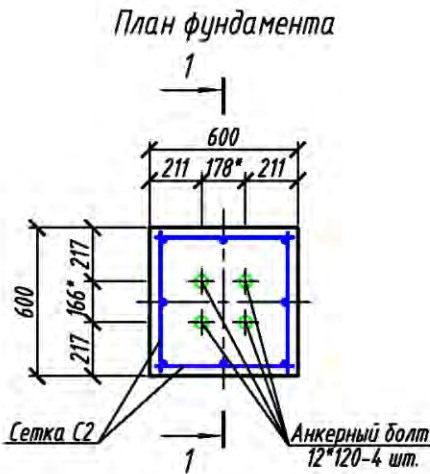
Установка автоматического шлагбаума "ПРЕПОНА-R2000 (R3000)" с устройством фундамента
