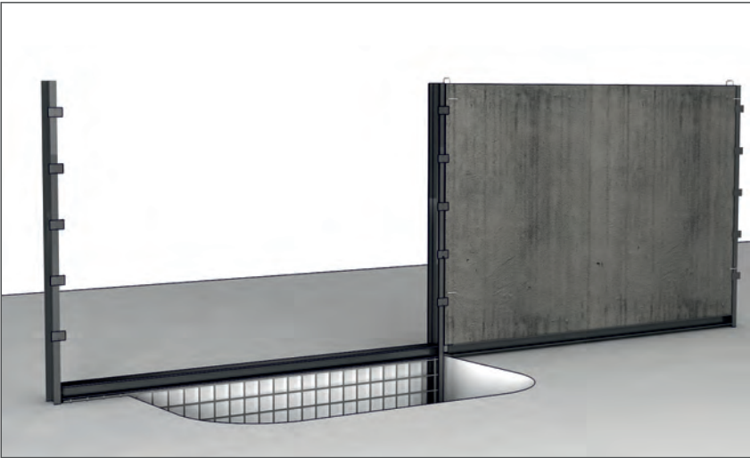
Установка панелей в заранее смонтированный металлический каркас
