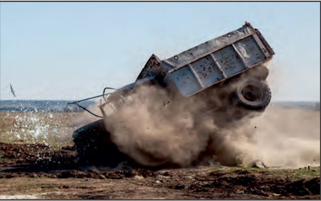
Натурные технологические испытания болларда
