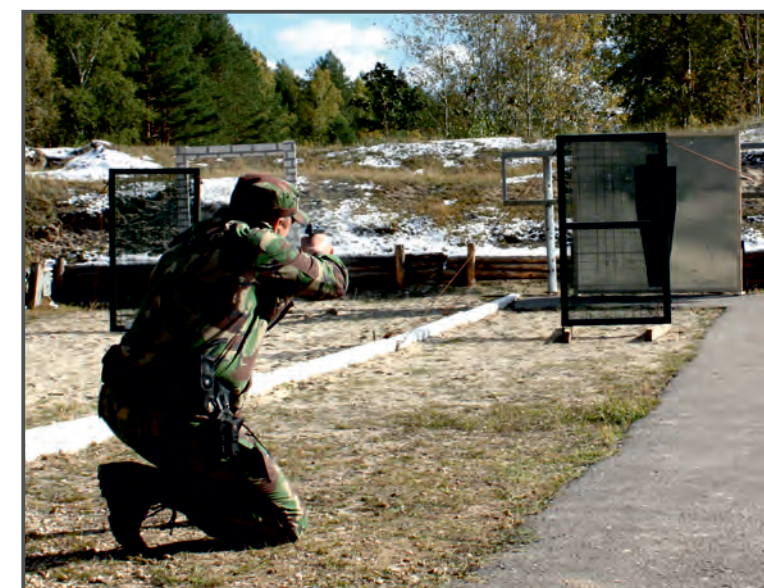
Обстрел сетки из пистолета Макарова штатным патроном
