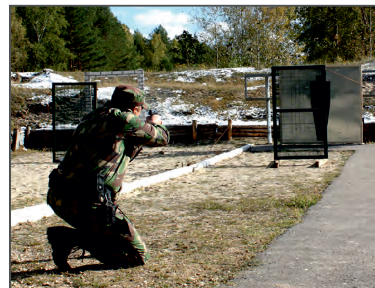
Обстрел сетки из пистолета Макарова штатным патроном
