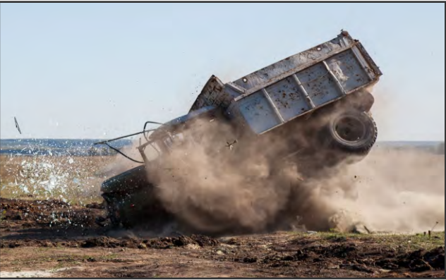
Натурные технологические испытания болларда
