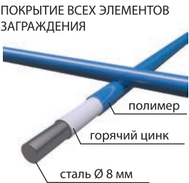
Полотно заграждения - сварная сетчатая панель ПАЛЛАДА-8 С150
