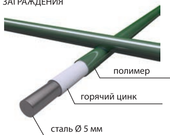
Полотно заграждения - панель МАХАОН®-Стандарт и АКЛ
