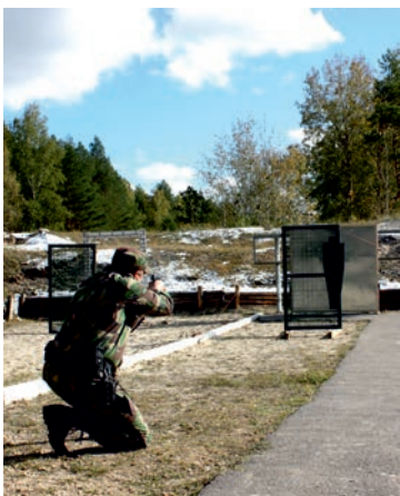
Обстрел сетки из пистолета Макарова штатным патроном
